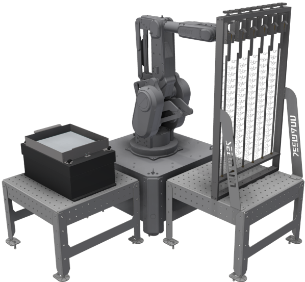
Automatische Bestückung von Stabgestellen (Bild: Seemann)
